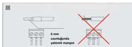
**Dikkat!** Bağlantı kablolarının uçları, yandaki şekilde gösterildiği gibi yalıtımlı mansonlar kullanılarak delaminasyona karşı korunmalıdır.
